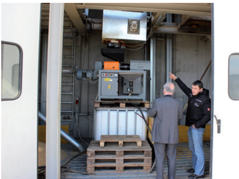
■ Die Verarbeitung beginnt oben im Sojatoaster, darunter befindet sich die Ölpresse, die das Öl in den darunter liegenden Tank fördert; das fertige Futtermittel wird nach rechts ausgestoßen und kann aufgefangen werden.
